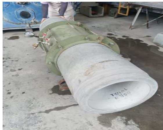
Gambar 13. Pelaksanaan Uji kebocoran pada sambungan pipa jacking yang dilakukan dengan sistem tekuk
