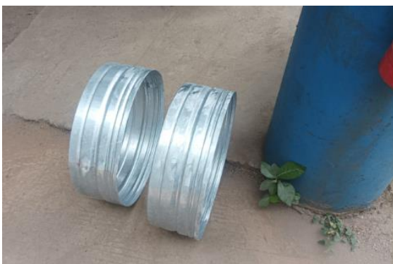
Gambar 26. Jenis Steel Collar bergelombang yang telah di galvanize Sumber Foto Dusaspun
