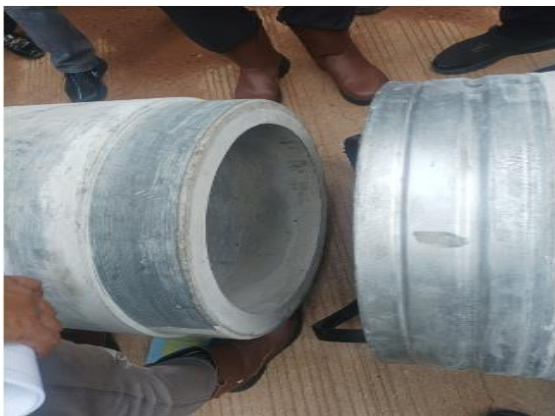
Gambar 25. Sambungan Steel Collar bergelombang yang harus di lindungi dari benturan Sumber JSWAS 2018
